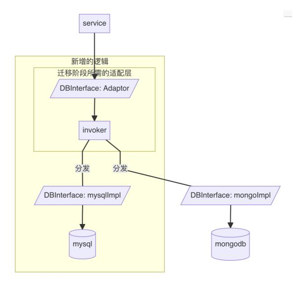
为了能在运行时控制读写调用的控制流,我们引入了一个新的 db 层实现,它在迁移过程中将直接接收来自上层的调用,并负责根据开关状态将调用分发到具体的 mongo/mysql 实现中。
